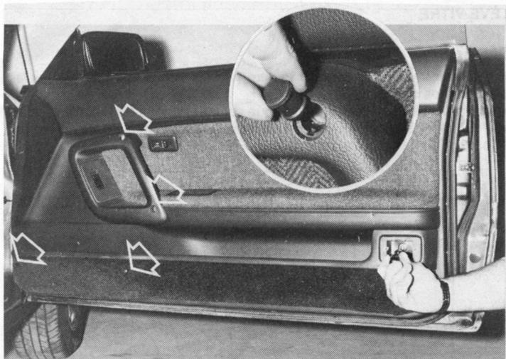
Repérer les cache-vis car ils sont différents afin d'épouser les courbes extérieures des logements qui les emprisonnent. Les flèches et le tournevis indiquent les emplacements des vis de fixation.
