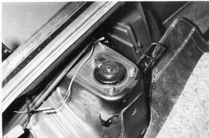
Même principe de fixation, pour la jambe Mc-Pherson arrière, que pour celle de devant : 3 écrous, accessibles après dégarnissage.
