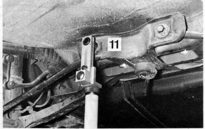
**Point de contrôle n° 11 :** fixation arrière du bras arrière de suspension. Embout L sur renvoi d'angle B, support n° 1, hauteur 78 mm, longueur 3622 mm, largeur 101 ± 5 mm.
