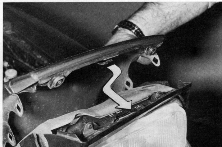
Une languette, située sur le couvre-projecteur, doit venir se loger sous un étrier du bâti escamotable.
