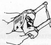
Soudure électrique par points
