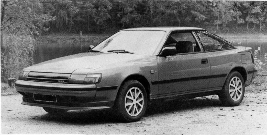
La Toyota Celica 2,0 GT (lift-back) est une traction avant à quatre roues indépendantes, isolées par quatre suspensions Mc-Pherson. Sa ligne en coin est pure, grâce à l'adoption de phares escamotables à l'avant (notons à ce sujet la présence d'un dispositif de coupure automatique des phares, pour éviter la décharge de la batterie, en cas d'oubli de la part du chauffeur).
