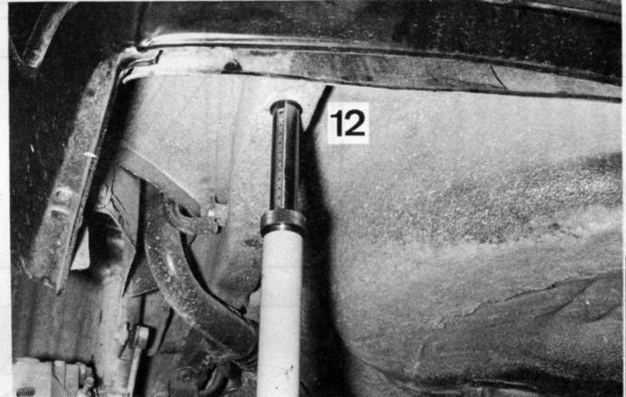
**Point de contrôle n° 12 :** trou pilote dans longeron arrière. Embout L, support n° 2, hauteur gauche 112 mm, droite 124 mm, longueur gauche 4081 mm, droite 4061 mm, largeur gauche 500 mm, droite 504 mm.
